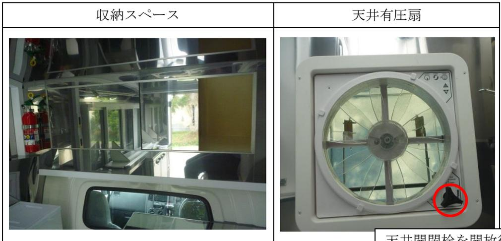
天井開閉栓を開放後、スイッチを入れてください。使用後は必ず閉めてください。
