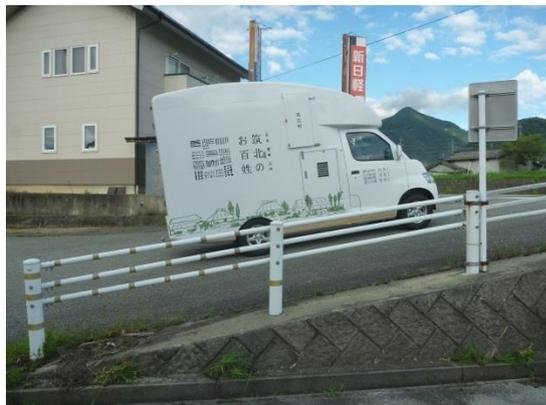
給水口の位置の関係で全ての水を排水できないため、斜面に駐車し、車体後部を傾けた状態で、可能な限り水抜きをし、その後スポンジ等で水を吸い出して排水してください。給水タンク内に水が残ることの無いようお願いいたします。
