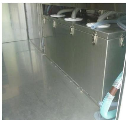
排水タンクは、初期不良により蓋が開かないため（※現在対応中）、車体後部を傾けて可能な範囲で排水をお願いします。
