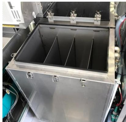
給水ポンプ取付口にポンプをつないで水を入れるか、給水タンクのふたを開けて直接水を入れます。最大容量は 200ℓ です。
